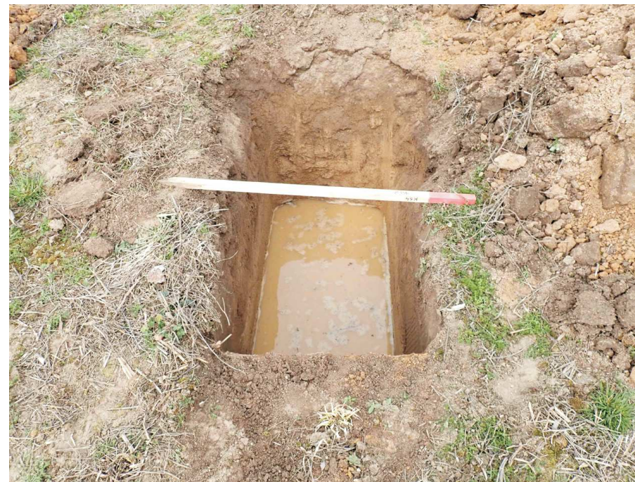
Foto 2. Realizace vsakovací zkoušky v kopané sondě KNS8.
