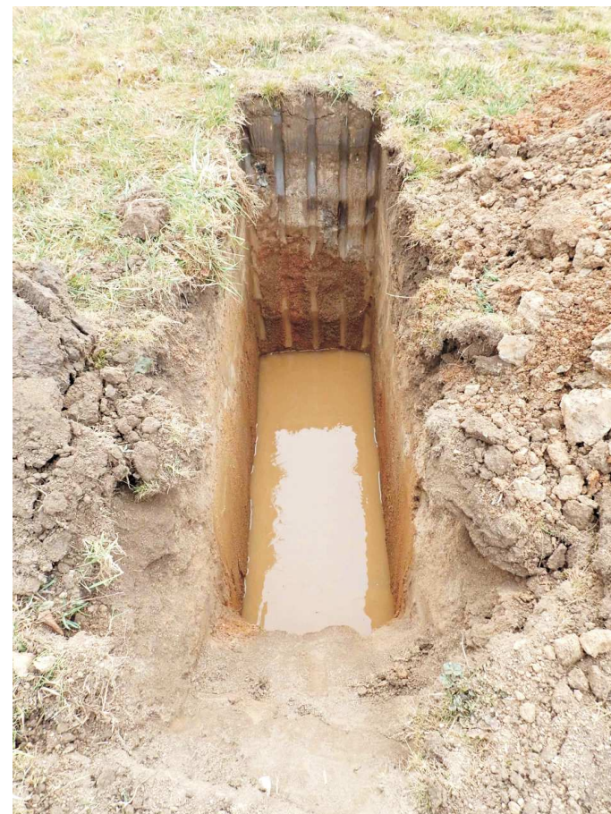
Foto 5. Podzemní voda v kopané sondě KS6.
